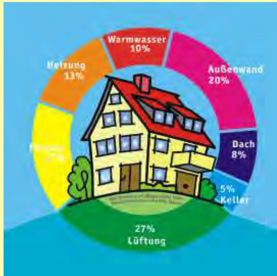
Wärmeverlust am Beispiel eines Mehrfamilienhauses aus den 60er Jahren.
